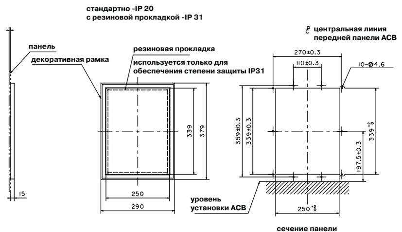
\* Закрепите декоративная рамку со степенью защиты IP20 в 6 крепежных отверстиях, а декоративная рамку со степенью защиты IP31 в 10 крепежных отверстиях.
